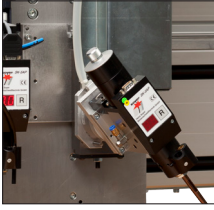
Option: Schwenkbare Schweißkopfchse Option: Rotatable welding head axis
